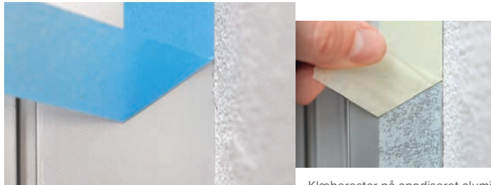
Klæberester på anodiseret aluminium.
