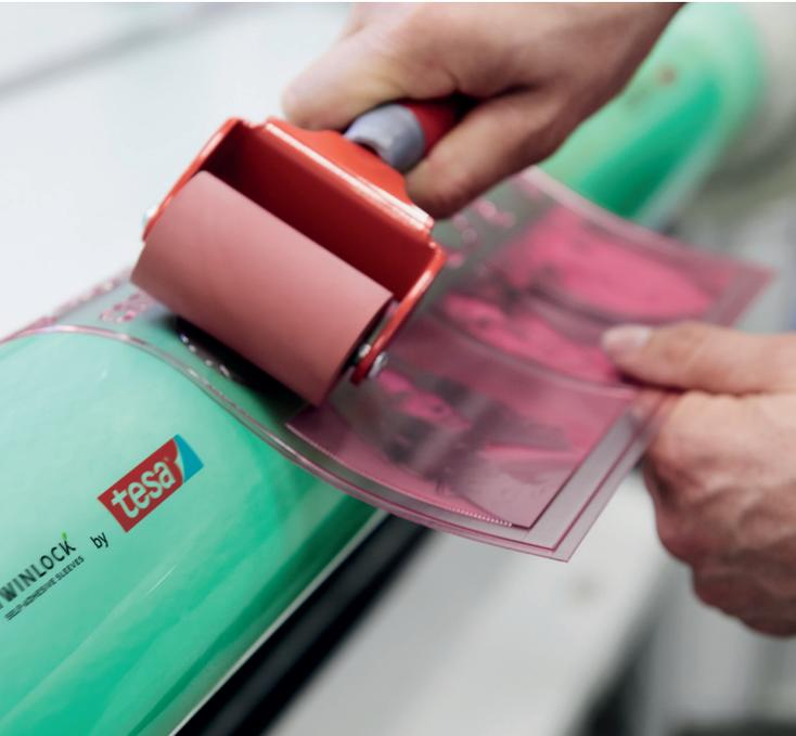
tesa Twinlock® ist eine selbstklebende Hülse oder ein Zylinder mit einer integrierten kompressiblen Schaumschicht für die Montage von Flexodruckplatten.
