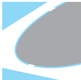
Stanzteile auf Rolle, mit Haltestegen partiell befestigt
