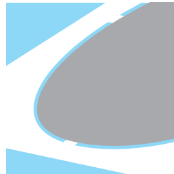
Stanzteile auf Rolle, mit Haltestegen partiell befestigt
