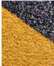
**tesa® 60954 Anti-Rutschband extra stark** wurde speziell für Hochleistungsanwendungen mit starker Dauerbeanspruchung z.B. durch Baufahrzeuge oder für Plattformen und Rampen entwickelt. Der äußerst strapazierfähige Träger besteht aus einer mit großen Mineralpartikeln beschichteten PVC-Folie für zusätzliche Rutschfestigkeit unter extremen Bedingungen. Die leuchtend gelben und schwarz-gelb gestreiften Bänder sind zur einfachen Identifizierung gut sichtbar.
