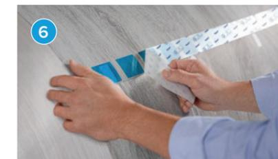
Retire con cuidado el revestimiento en la dirección de las etiquetas de empalme. ¡Listo para empalmar!
