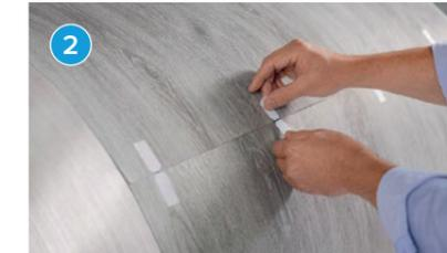
Aplique las etiquetas de separación a una distancia adecuada en toda la anchura de la bobina.
