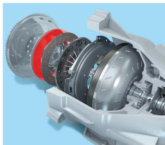
Unión de revestimientos de fricción de carbono sobre metal, por ejemplo, para embragues
