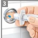
接着剤アプリケーターの先端をアダプターの注入口に差し込み、注射器のように接着剤を注入する。空気穴から接着剤が出てくるまで注入すること。
