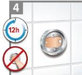
完全に硬化するまで12時間放置する。(壁面に押しつけないこと)
